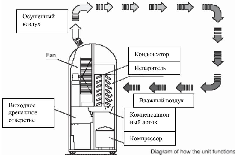
Осущеный, охлажденный воздух вновь разогревается в **конденсаторе** (радиаторе), а затем выводится наружу с температурой примерно на 5 градусов выше комнатной температуры. Этот воздух, который теперь стал сухе, вновь смешивается с окружающим воздухом. Относительная влажность воздуха постепенно сокращается до желательного значения относительной влажности, с помощью непрерывной циркуляции внешнего воздуха через установку.
