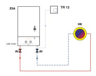
Управление работой котла осуществляется с помощью комнатного регулятора TR 12
