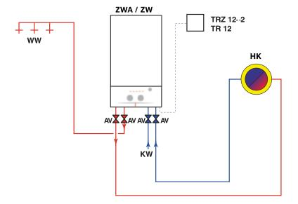
TR 12, TRZ 12-2 – регулятор температуры помещения WW – подача горячей воды для пользователя KW – подача холодной воды в бойлер AV – запорная трубопроводная
