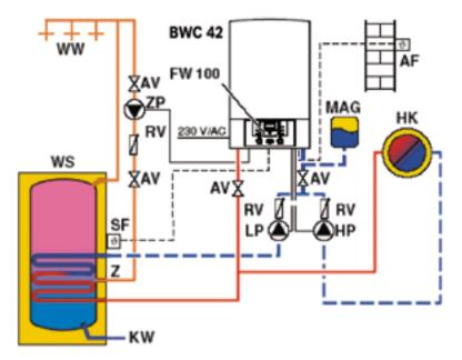
АF – датчик наружной температуры МАG – мембранный расширительный бак FW 200 – погодный регулятор температуры НК – контур отопления НР – насос контура отопления, макс. 200 Вт WW – точки водоразбора WS – бойлер косвенного нагрева SF – датчик температуры в бойлере Z – контур рециркуляции KW – подвод холодной воды RV – обратный клапан AV – запорная арматура LP – загруочный насос бойлера
