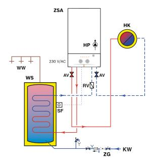
**HP** – насос контура отопления
