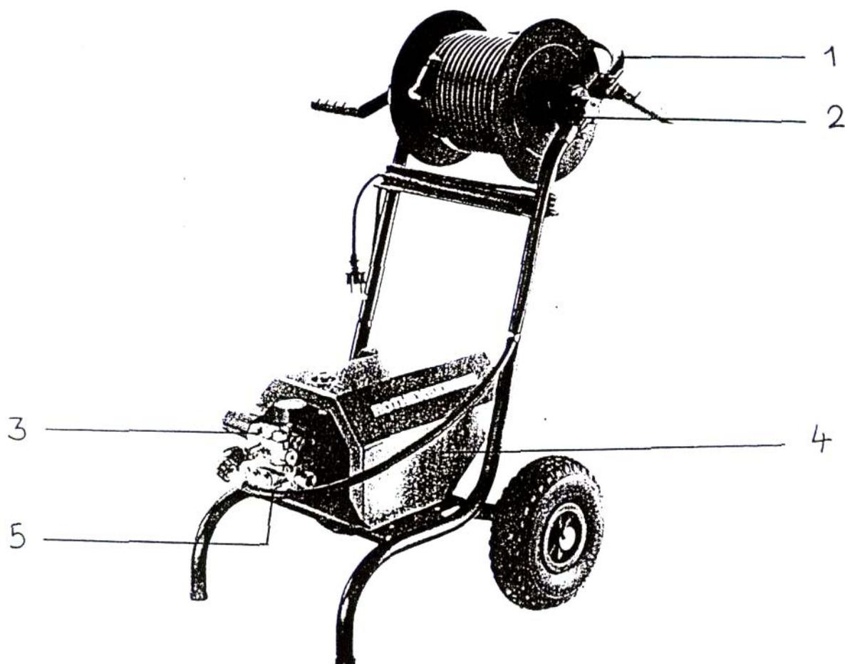
Прочистная машина высокого давления **HD 13/100** с двигателем переменного тока является самовсасывающим компактным аппаратом и применяется для прочистки трубопроводов, канализационных и сточных труб размером от 40 до 150мм и максимальной длиной прочистки до 30м.
