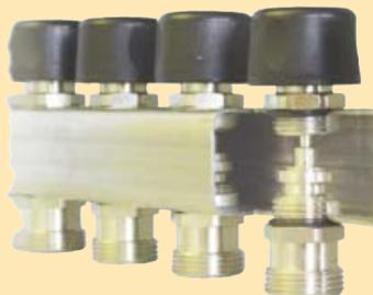
INOX-распределители оборудованы **соответствующей стандарту DIN EN 1264-4 клапанной техникой**. Это означает, что функция регулировки количества воды и функция ее перекрытия разделены.
