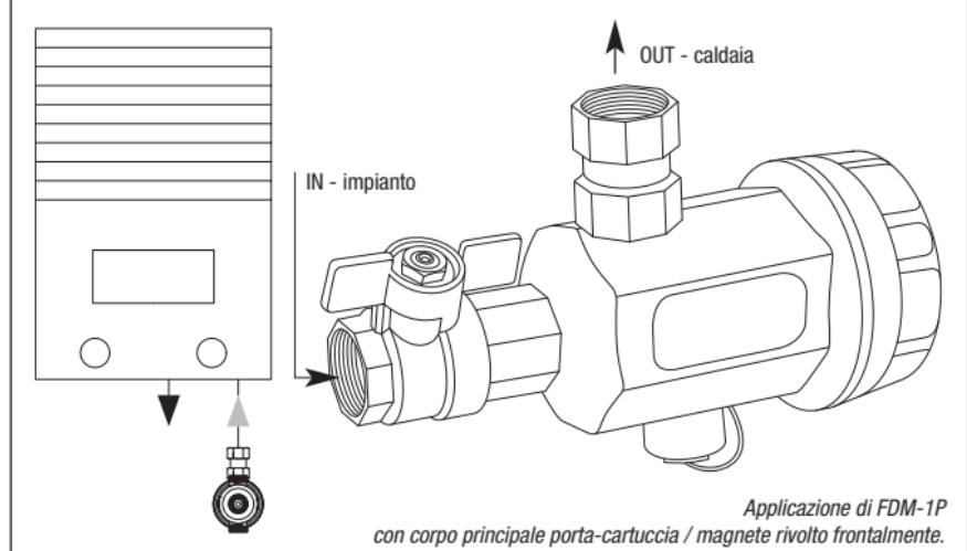
**ATTENZIONE:** prima di eseguire qualsiasi operazione di installazione o manutenzione, assicurarsi che l'impianto di riscaldamento sia isolato. E' consigliato installare FDM-1P sul circuito di ritorno, in ingresso della caldaia, per proteggerla da tutte le impurità presenti nell'impianto, soprattutto nella fase di avviamento. (Schema A)
