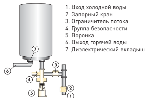
СХЕМА ПОДКЛЮЧЕНИЯ ДЛЯ НАСТЕННЫХ ВЕРТИКАЛЬНЫХ МОДЕЛЕЙ
