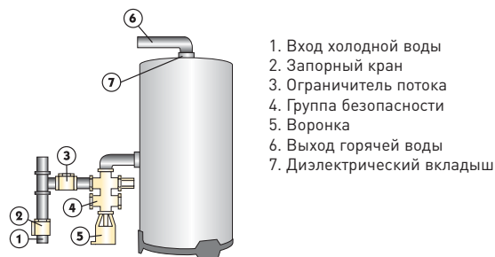
СХЕМА ПОДКЛЮЧЕНИЯ ДЛЯ НАПОЛЬНЫХ МОДЕЛЕЙ
