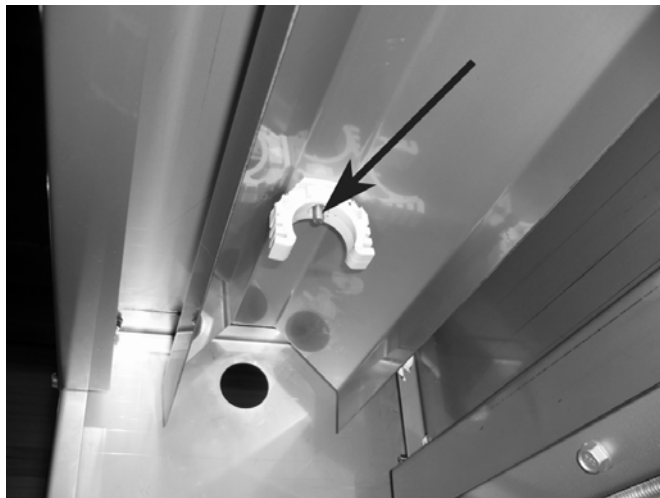
Рисунок 12: Пластиковый держатель с более длинным болтом
