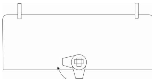
Для открытия крышки необходимо снять блокировку, поворачивая ее по часовой стрелке. После установки требуемой функции снова закрыть крышку.
