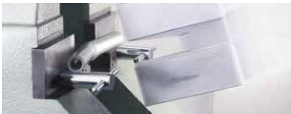
Рис. 2 Универсальная труба RAUTITAN flex в установке по испытанию ударной вязкости
