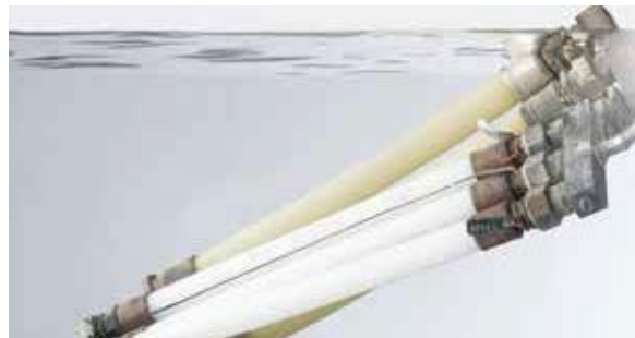
Рис. 4 Трубы в момент длительного испытания (под давлением в водном резервуаре)
