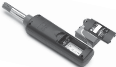
Figura 5 – Sostituzione della batteria
