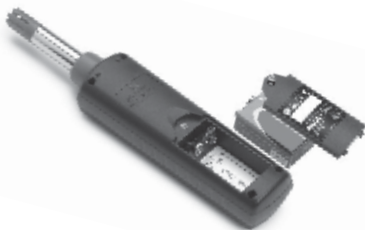
Figura 5 – Reemplazo de la batería
