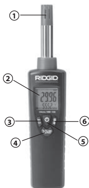
Obrázek 3 – ovládání teploměru a vlhkoměru micro HM-100
