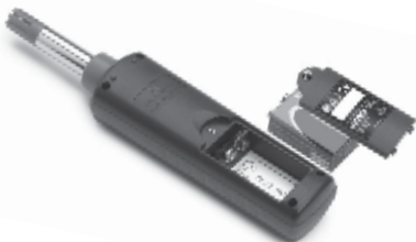
Figura 5 – Substituição da Pilha
