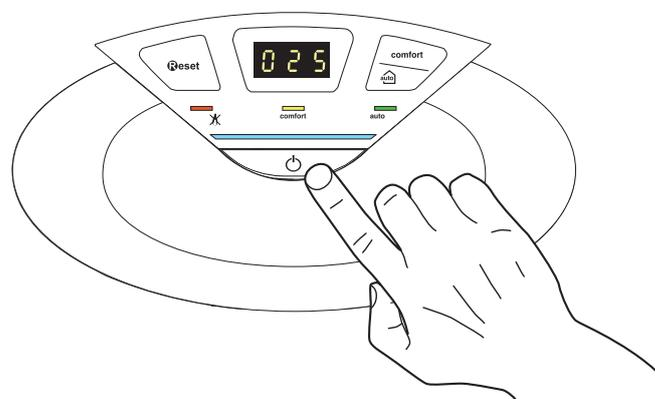
Pentru a opri definitiv cazanul, poziționați întrerupătorul electric extern pe OFF; displayul se va stinge. Închideți robinetul de gaz.
