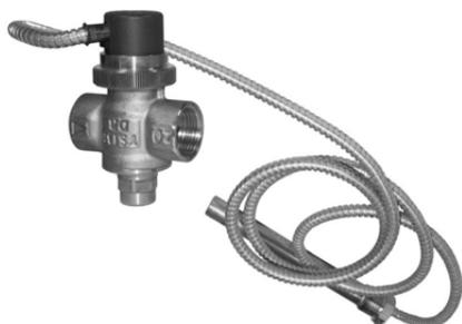
Термостатический регулирующий вентиль срабатывает по температуре воды в котле. Он состоит из клапана со сжатой пружиной и сильфонного датчика температуры. Когда температура в котле достигает 95°C, усилие, оказываемое сильфоном, превышает усилие, развиваемое пружиной, и она распрямляется. Холодная вода из водопровода начинает поступать через аварийный теплообменник. Таким образом, снимается избыточное тепло, и котёл не перегревается.
