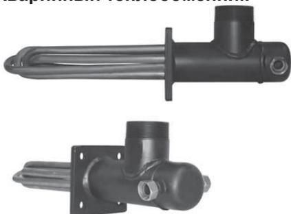
Аварийный теплообменник устанавливается непосредственно в подающий патрубок котла. В наружной части теплообменника имеется два штуцера для присоединения термостатического предохранительного клапана и для отвода горячей воды.
