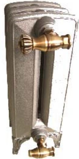
Jeder Heizkörper wird individuell bis auf 19 Gliederblöcke zusammengestellt und besitzt mindestens zwei ( bis 12 Glieder ) angegossene Standfüße. Ab einem 13-Glieder-Block werden drei Standfüße vormontiert, so dass nur ungerade Gliederblöcke ausgeliefert werden.
