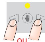
Установить желаемую температуру подачи отопления, нажимая на кнопку или .
