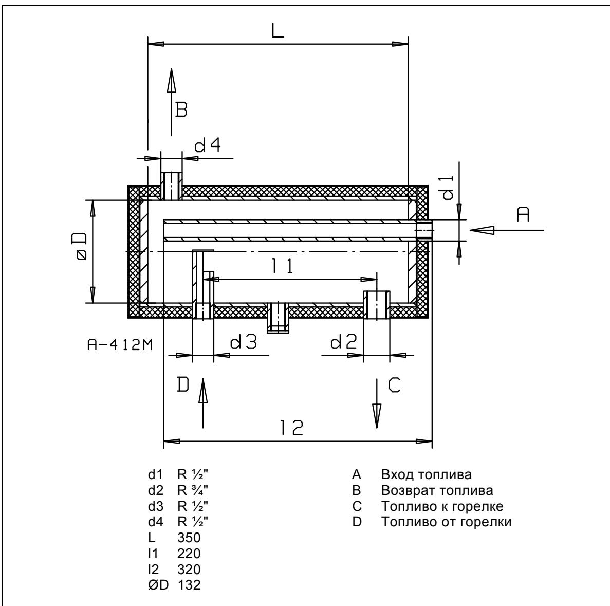
При монтаже деаэратора, предназначенного для удаления газа и воздуха из топлива, необходимо учитывать правильное направление течения топлива.
