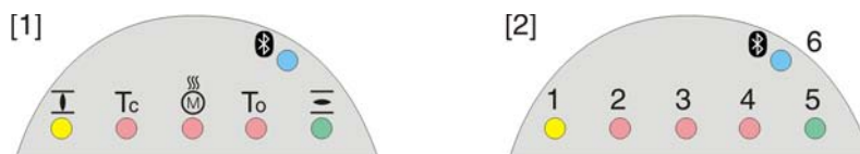
рис. 61: Расположение ламп и описание ламповой индикации
