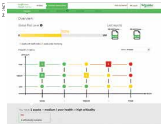
Матрица технического состояния в Asset Advisor
