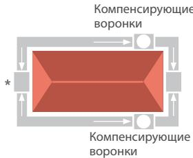
Если водосточные желоба образуют замкнутую систему, как показано на рисунке, необходимо обеспечить одновременное использование компенсирующих воронок и компенсаторов.
