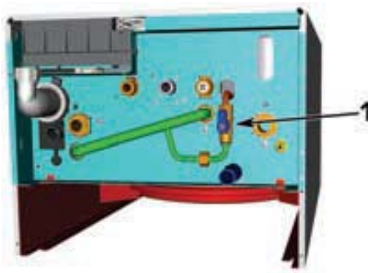
рис. 15 - Кран для заполнения системы отопления
