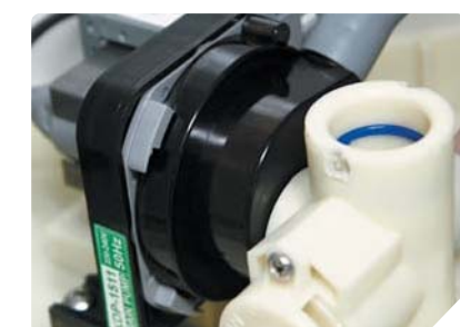
Дренажная помпа с защитой от попадания частиц накипи
