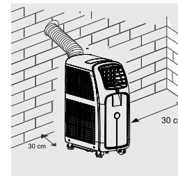
1. Выберите подходящее место для установки кондиционера с удобным доступом к электрической розетке.
