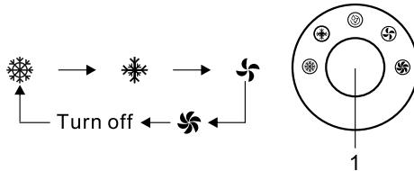
Индикация символа означает, что устройство будет работать в режиме охлаждения при высокой скорости вентилятора.
