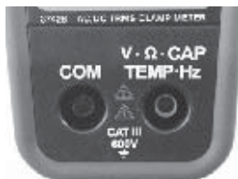
Figura 7 - Terminais de entrada
