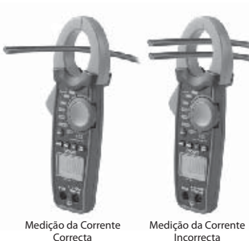
Figura 8 - Forma correcta de medição da corrente
