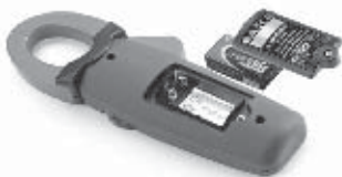
Figura 5 – Sostituzione della batteria
