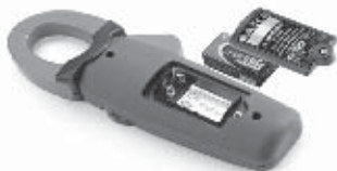
Fig. 5 – Udskiftning af batteri
