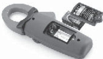
Figure 5 – Remplacement des piles
