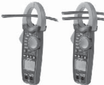
Misurazione della corrente corretta
