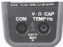
Figura 7 – Terminali di ingresso
