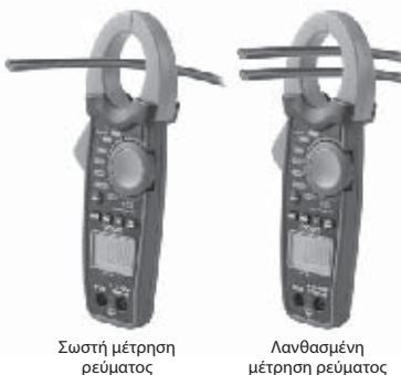
Εικόνα 8 – Σωστός τρόπος μέτρησης ρεύματος
