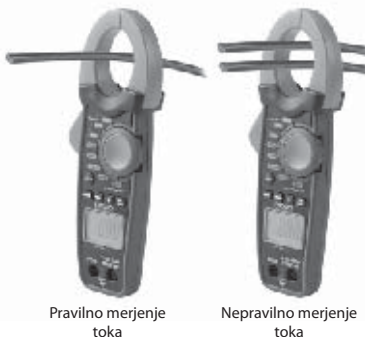
Slika 8 – Pravilno merjenje toka
