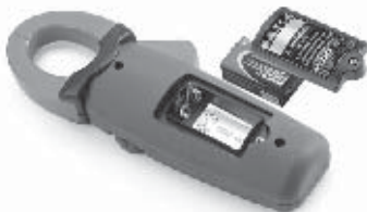
Figura 5 – Reemplazo de la batería
