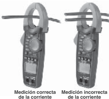
Figura 8 – Forma correcta de medir la corriente
