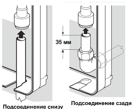
Рис. 11 Подсоединение трубы холодного водоснабжения
