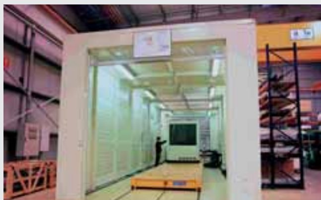
Все чиллеры проходят заводские испытания, в ходе которых они проверяются путем имитации фактических условий эксплуатации.
