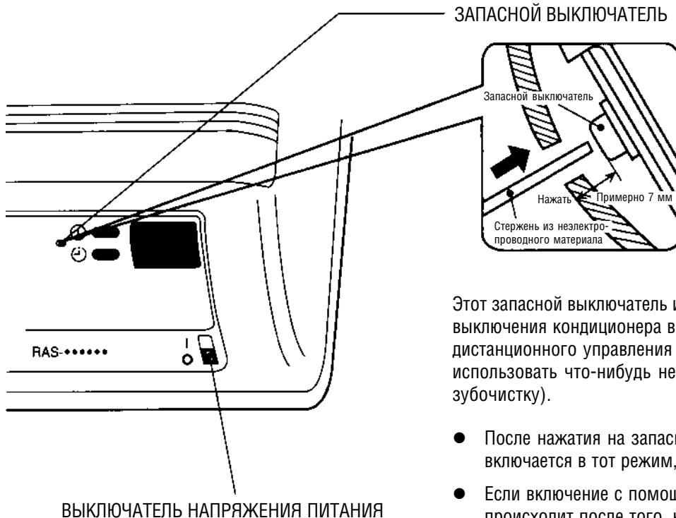
Этот запасной выключатель используется для включения и выключения кондиционера в случае, если пульт дистанционного управления не работает. Следует использовать что-нибудь неэлектропроводное (например, зубочистку).
