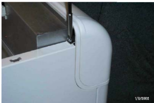
Рис. 5 – Отвинтите и выньте два винта и две пластинки, удерживающие панель управления.
