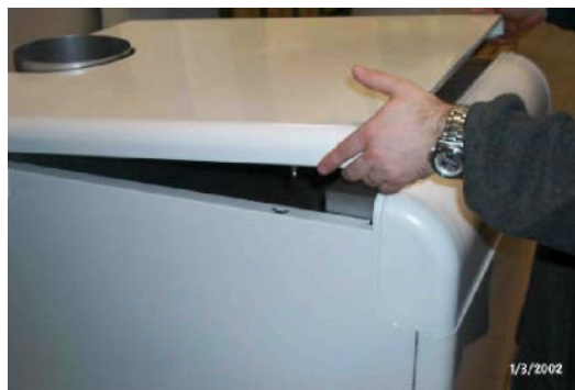
Рис. 4 – Приподнимите крышку, надавливая снизу вверх, снимите крышку, которая удерживается по бокам стерженьками, входящими в пазы.
